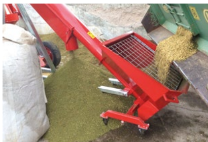
ZZ40 beim Reinigen von Sommergerste aus Öko Anbau mit sehr hohem Besatz
